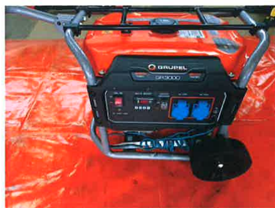
Agregat prądowórczy GRUPEL GR 3000W. 230V,50Hz, 12A, 2,8kW, 3,0kW,45kg.
