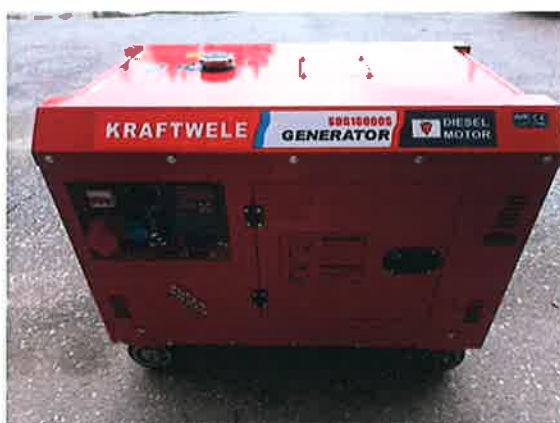
Agregat prądowórczy KRAFTWELE SDG 16000 TYP SDG16000 SILENT MODEL BD18000 MAX OUTPUT-16.0 kVA RATED OUTPUT 14,0 kVA.
